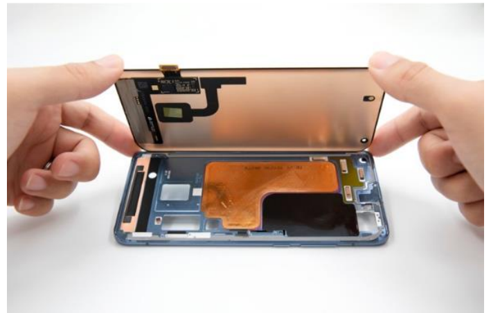
图 15: 小米 10 手机采用市面上最大面积的 VC
