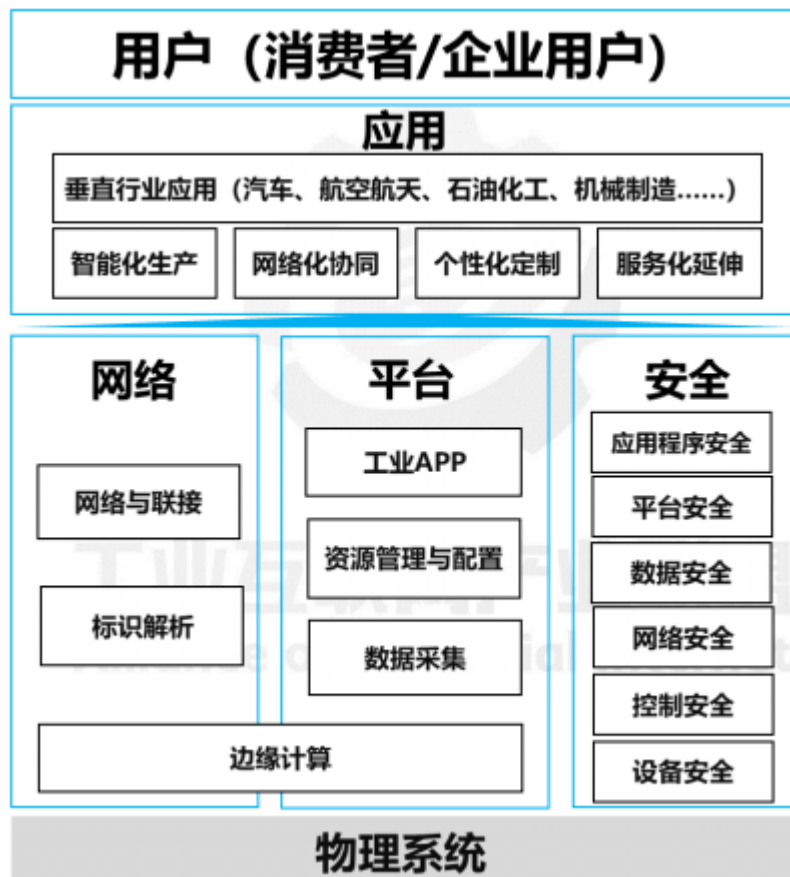
图42：工业互联网的体系架构示意图
