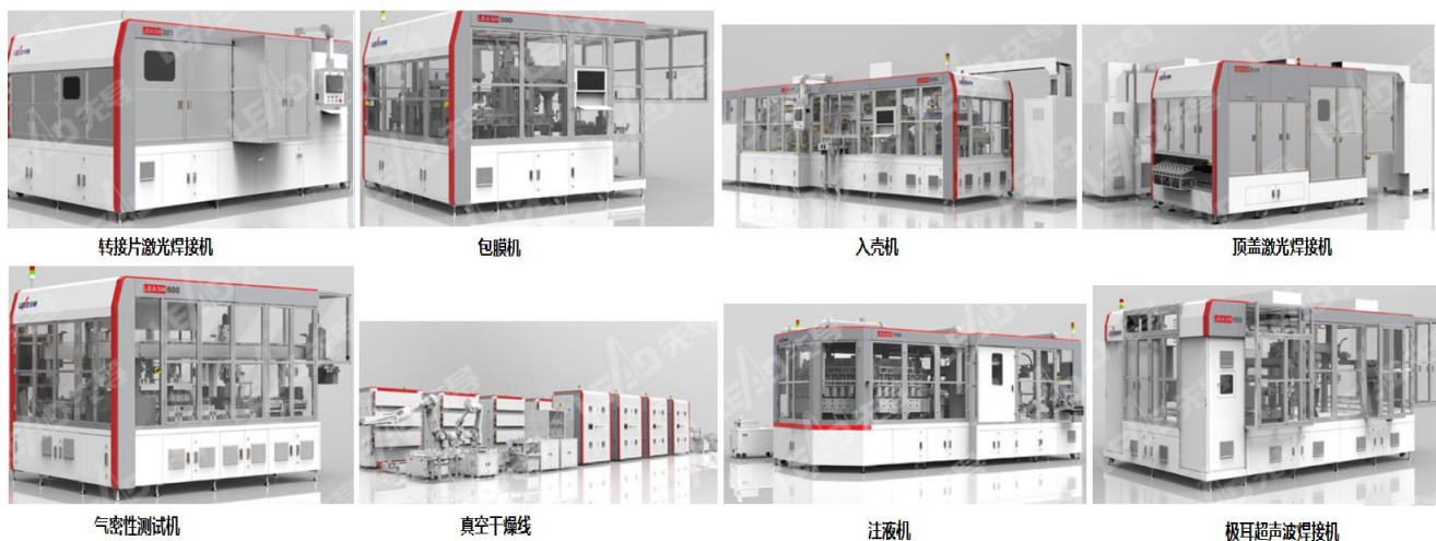
图 77：组工程核心设备—转接激光焊接机，包膜机，入壳机，顶盖激光焊接机，气密性检测机，真空干燥线，注液机等
