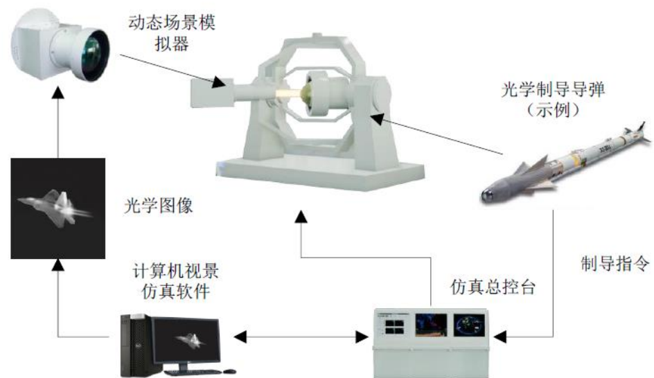
图 11: 新光光电核心产品红外数字微镜阵列场景仿真系统
