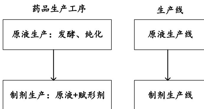
对应前述生产工序，标的公司的生产线分为原液生产线和制剂生产线：原液为中间产品，生产完成后交由制剂生产线，最终生产生长激素、促卵泡激素等产品成品。因此，标的公司主要产品的实际产能受到原液生产线产能和制剂生产线产能的限制。报告期内，标的公司原液生产线和制剂生产线的产能利用率具体情
